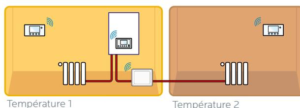
Installation à 3 zones chauffage avec émetteurs différents, module H Visio et module circulateur intégré dans la chaudière
