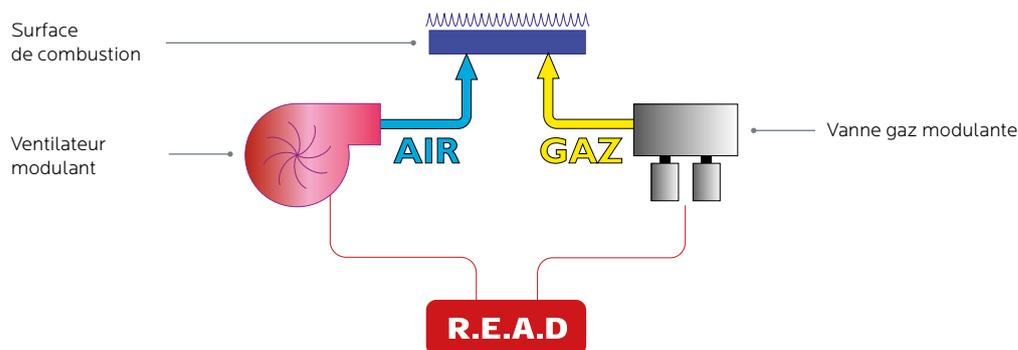
Aucun réglage manuel : avec FLATFIRE® et son dispositif READ® intégré, c'est l'assurance d'un **rendement de combustion permanent**.
